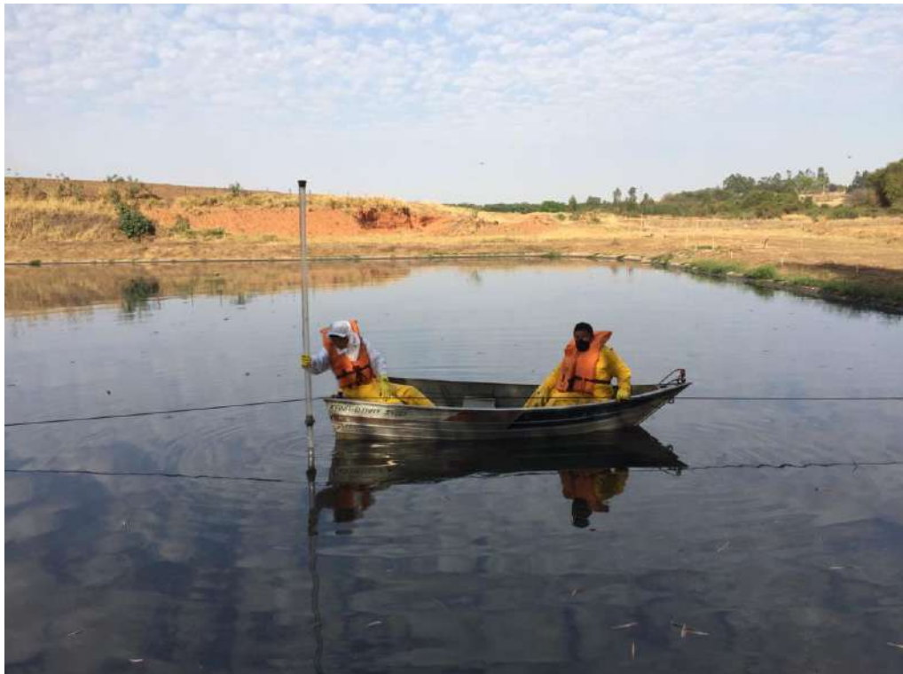
Foto 1: Medição das profundidades de lodo com tubo graduado.
