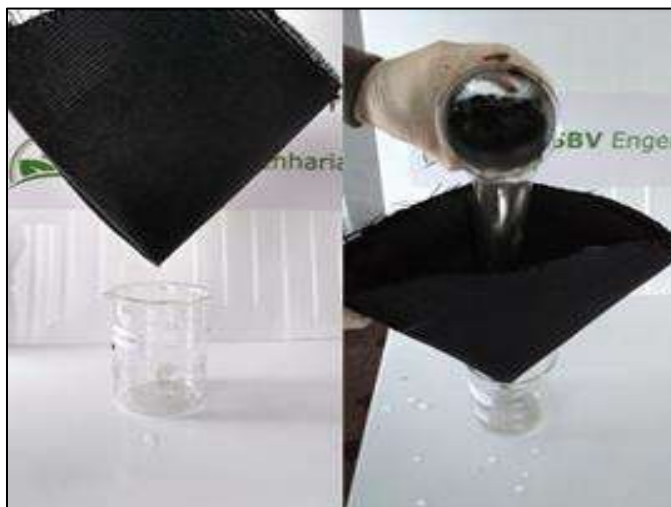
Figura 7. Teste com Cone de Geotêxtil.
