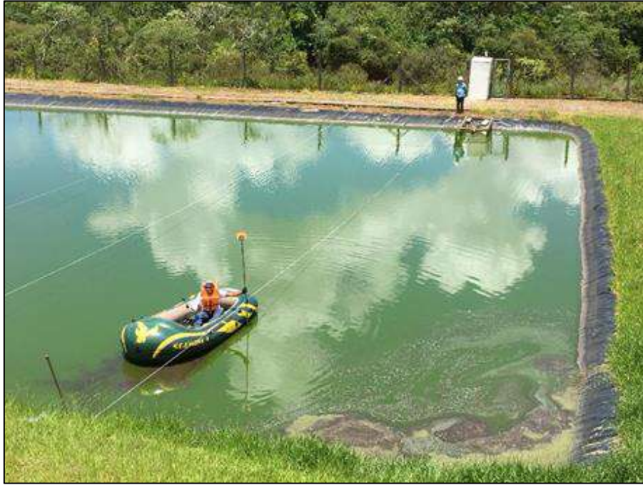
Figura 5. Posicionamento do barco nas cordas demarcadas para levantamento topo-batimétrico.
