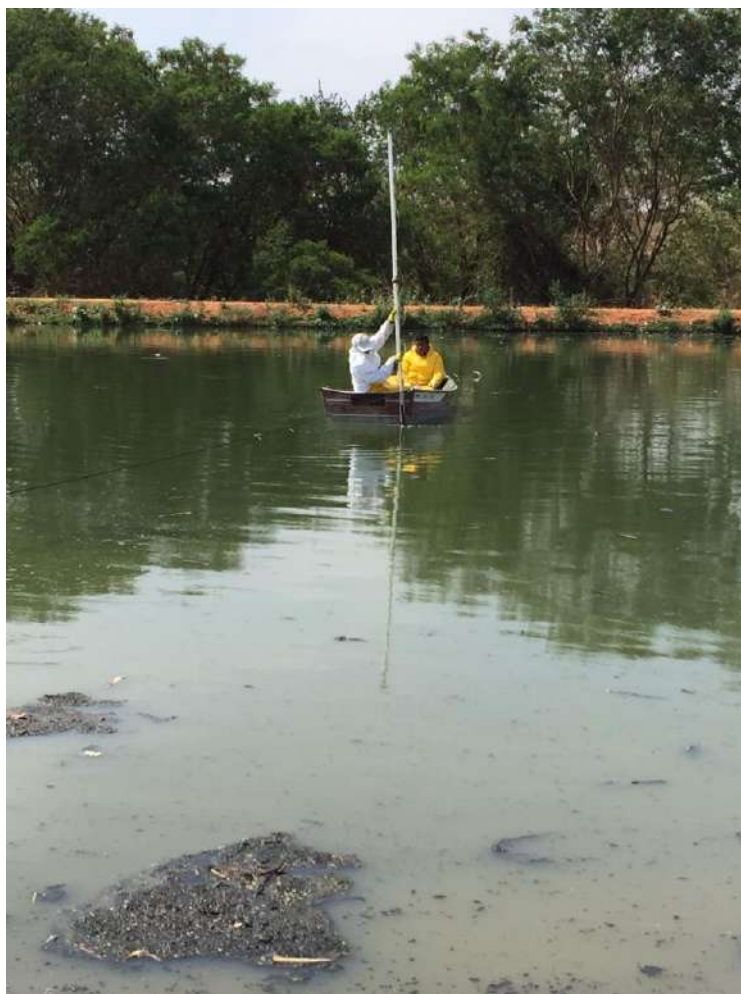
Foto 3: Medição das profundidades de lodo com tubo graduado.
