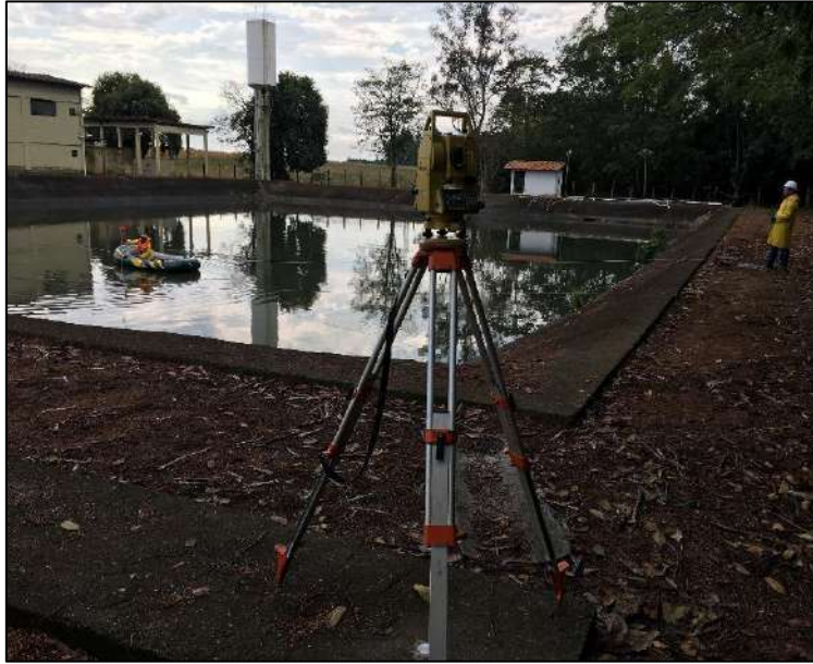
Figura 3. Estação total posicionada para levantamento topo-batimétrico.
