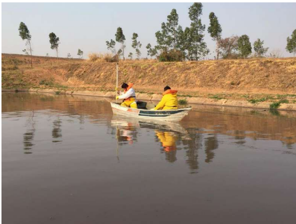
Foto 2: Medição das profundidades de lodo com tubo graduado.
