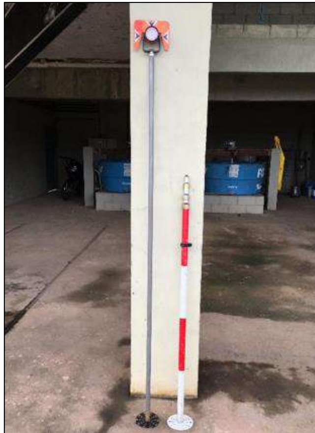
Figura 4. Varejão com chapa para levantamento da superfície de lodo.
